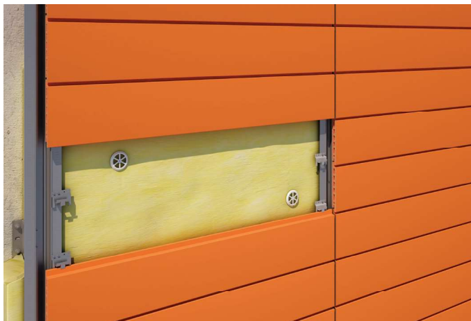
Détail partie courante ossature métallique
