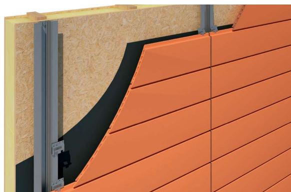
Détail partie courante mur ossature bois
